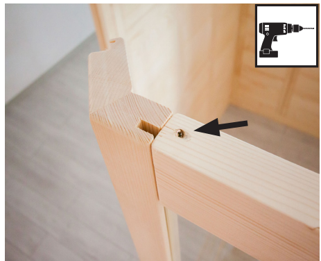
Broca de 3 mm, 1 parafuso de 4 x 70 mm
