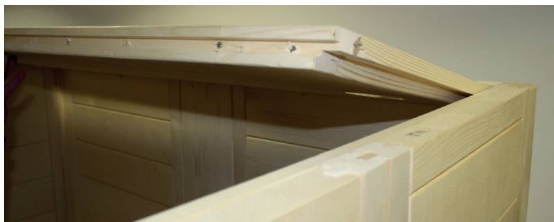
Fig. 18: Inserimento dell'elemento tetto anteriore
