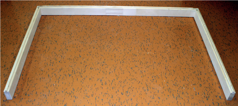
Afb. 1: Plaatsen van de drie bodemframe-elementen
